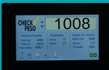
Como opcional aos seus equipamentos, a CheckPeso disponibiliza Telas Touch Screen de 7 e 10 polegadas com processadores de 32 bits. O display e o teclado padrão são mantidos e podem ser utilizados, caso ocorra qualquer defeito na Tela Touch Screen, aumentando a segurança do equipamento uma vez que o mesmo continua funcionando.
